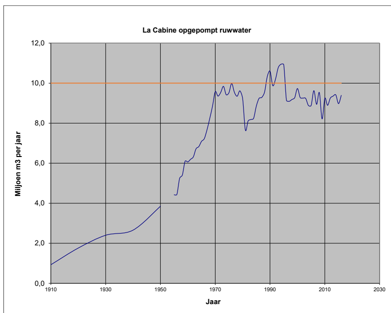
Figuur 2: Hoeveelheden opgepompt ruwwater winning La Cabine (bron: Vitens).
